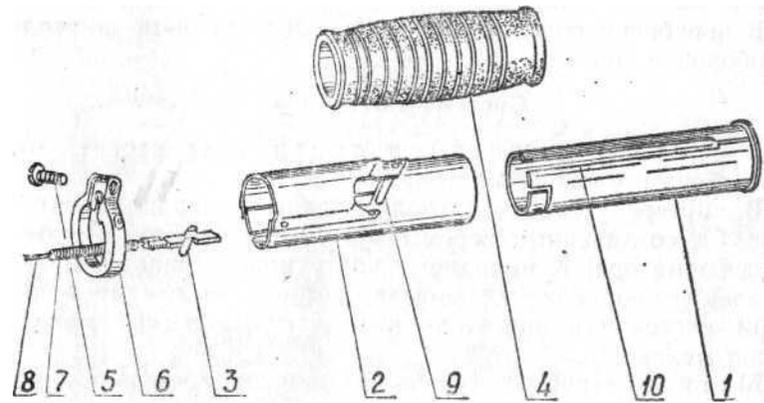
Рис. 4. Ручка управления дросселем карбюратора: 1—втулка внутренняя; 2—втулка наружная; 3—ползунок; 4—ручка; 5—винт хомутика; 6—хомутик; 7—оболочка троса; 8—трос; 9—паз винтовой; 10—паз продольный.
