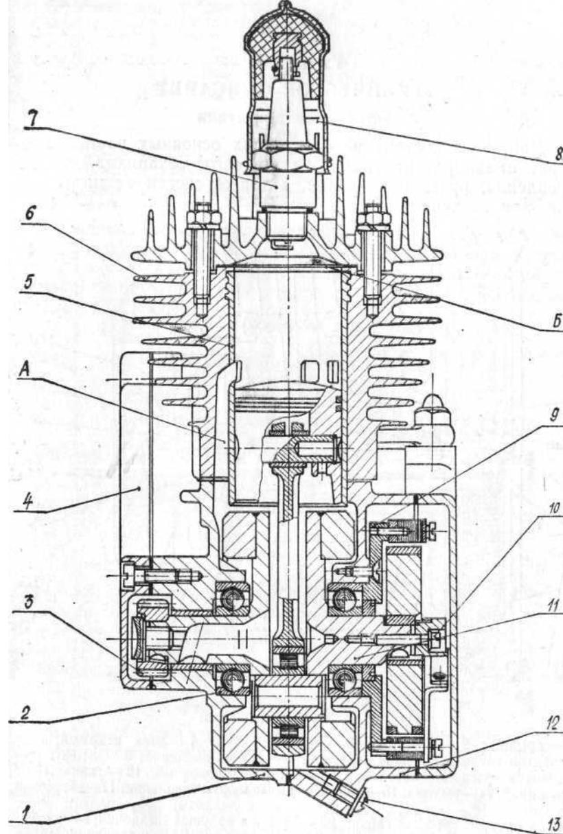
Рис. 2. Разрез двигателя:
